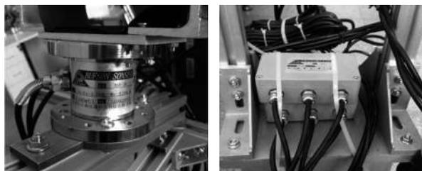
30N·M。变送器输出端采用三线制+24VDC,供电输出:2.5→±2.5VDC,电源端口:红色为正极,黑色为负极,输出端口是绿+。变送器及连线设有屏蔽线,如果需要可将传感器屏蔽线接地,调整零点及放大倍数,可分别调整电位器PZERO(w104)和幅点电位器SPAN(w101)。
