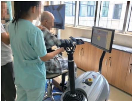
本研究采用ReoGo上肢康复机器人的六种运动轨迹,如图2,每种运动轨迹含有目标导向下的被动运动(Guided)、单点触发(Initiated)、多点触发(Step Initiated)、连续运动(Follow)和主动控制(Free)5种不同难度训练模式,每种训练模式下可根据患者情况设置不同的活动范围、阻力、运动速度等参数,在患者训练过程中,系统可针对患者不同的能力进行评估,如患者主动参与程度、动作平滑程度、主被动关节活动度、目标追踪准确性等,循序渐进为患者提供适当的挑战难度模式,让患者时刻主动参与到训练当中,提高患者主动参与兴趣,加速上肢功能和脑神经的恢复进程。
